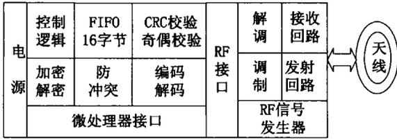
图1 SHC1701 读写模块(RWM)的组成
