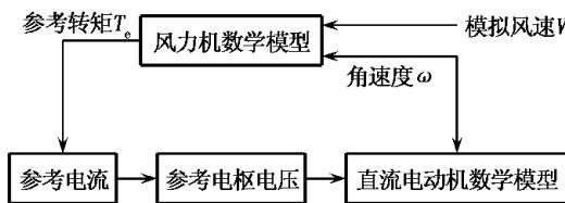
图 2 模拟风力机主要算法
