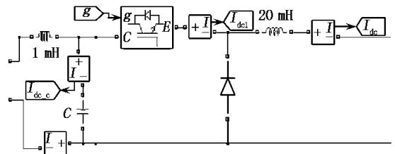
图 4 BUCK 降压斩波电路
