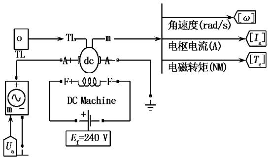
注:  $U_a$ —直流电动机的电枢电压,通过直流斩波控制;
